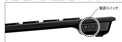
②電源をOFFにする場合は、電源スイッチをOFF側へスライドします。
